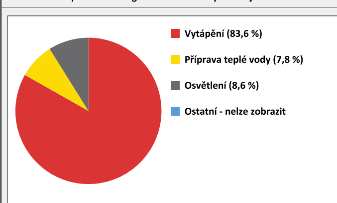
Podíl primární energie z neobnovitelných zdrojů dle účelu
