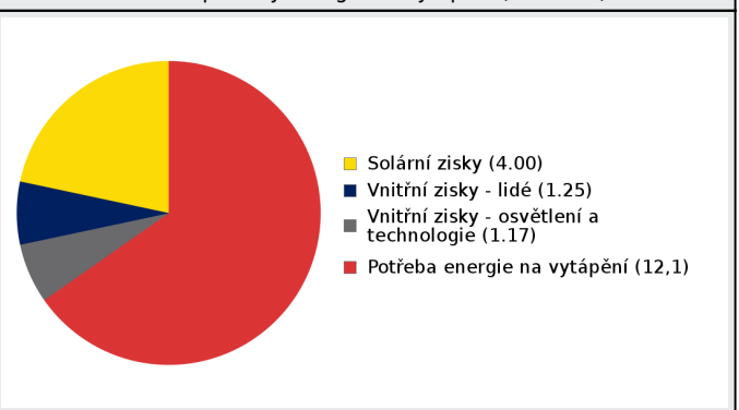
Bilance potřeby energie na vytápění (MWh/rok)
